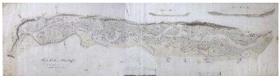
Abbildung 53: Karte von Breitingen 1811, die Sohlenbreiten betragen zwischen 100 m und 140 m (Abbildung 33) Fliessrichtung von rechts nach links
