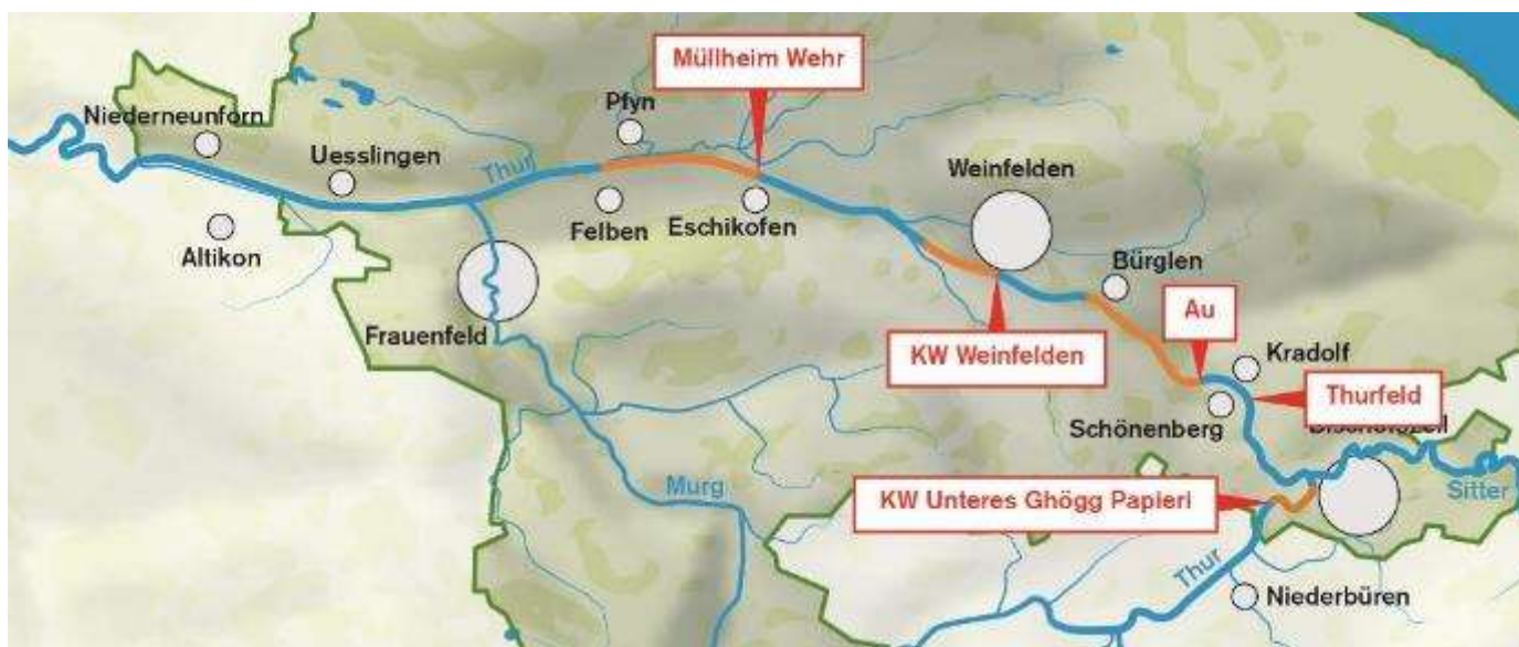
Abbildung 128: Abschnitte im Thurlauf die durch Kraftwerke und Wehranlagen beeinflusst werden (orange) und unbeeinflusste Abschnitte (blau) [5]
